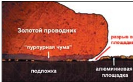
Рис. 9. Появление «пурпурной чумы» в месте контакта золота и алюминия
