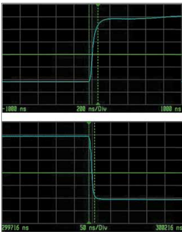
▲ Рис. 5. Формы нарастания и спада ВЧ импульса в случае управления напряжением на затворе
