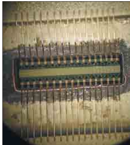
Рис. 5. 60-миллиметровый кристалл LDMOS
